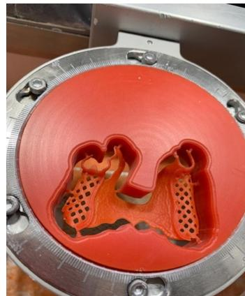
Usinage en cire d'un futur chassis métallique
