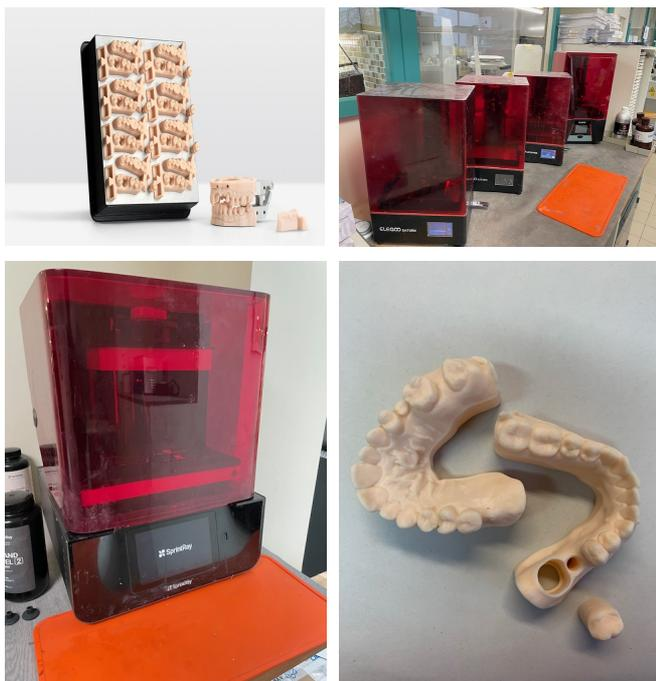
Modèles imprimés en résine 3D et imprimantes LCD
