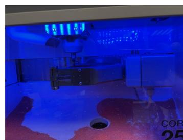
Usinage en cire d'un futur chassis métallique
